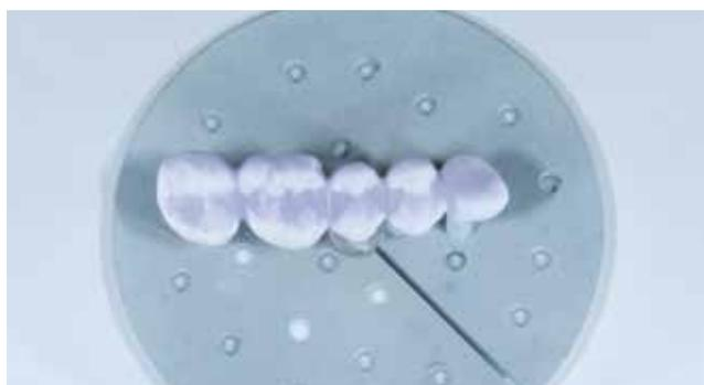
Prestare attenzione a posizionare possibilmente al centro dell'IPS e.max CAD Crystallization Tray.
