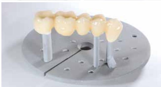
Detersione e controllo dopo il termine del programma di cottura
