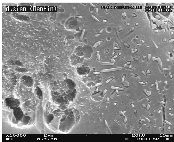
Fig. 2: Ingrandimento x 10'000 (SEM) dei cristalli di fluoro-apatite della massa dentina IPS d.SIGN dopo la mordenzatura del preparato. Le evidenti incisioni di mordenzatura mostrano la contemporanea esistenza di cristalli di leucite.
