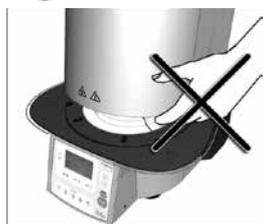
La cappa ha un azionamento elettrico e deve essere comandata tramite l'elettronica. Non aprire mai la cappa manualmente per non danneggiarne il meccanismo.
