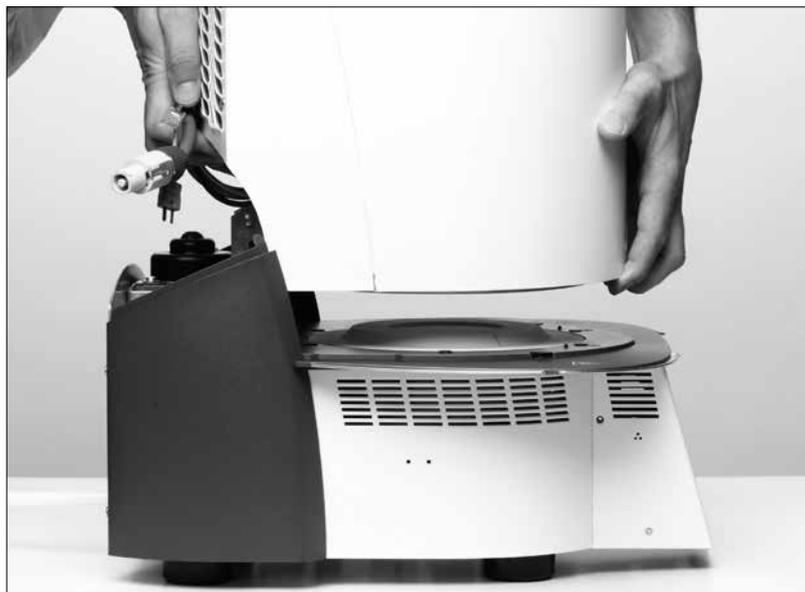
Assicurarsi che la tacca di demarcazione di montaggio della cappa (33) sia allineata con la tacca di demarcazione di montaggio della base del forno (34).
