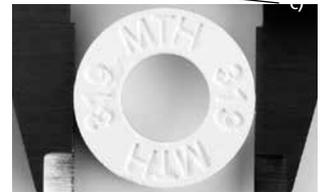
6. Cercare il diametro misurato nella tabella di calcolo e rilevare la temperatura. Aggiustare la temperatura soltanto se lo scostamento è superiore a 10°C.
