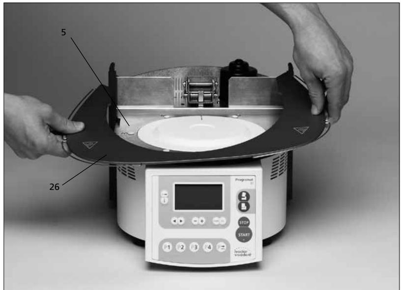
A questo punto fissare la piastra di appoggio (26) con le due viti di fissaggio (27) includendo la superficie in silicone (28).
