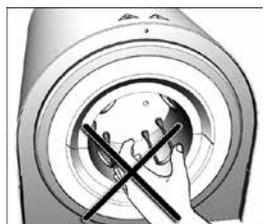
Non toccare il termoelemento e l'elemento riscaldante. Evitare qualsiasi contatto con la pelle (contaminazione da grasso) per non usurare più rapidamente le componenti.
