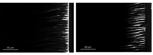
Micrografia al laser confocale della dentina trattata con Telio CS Desensibilizzante. Telio CS Desensibilizzante è stato miscelato con lo 0,1% di rodamina, un colorante fluorescente. Sopra: dentina non mordenzata con fango dentinale, sotto: dentina
