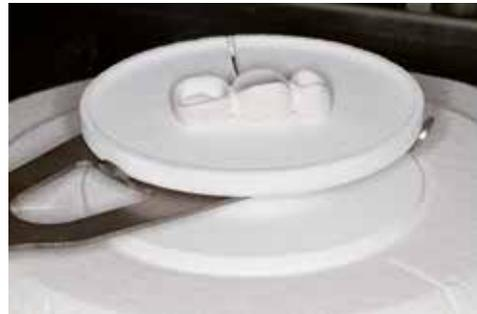
Con la forchetta di sinterizzazione, posizionare il piano di sinterizzazione completato al centro del Programat CS4.
