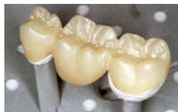
Posizionare subito il ponte sull'IPS e.max CAD Crystallization Tray.
