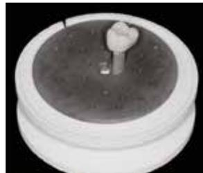
Posizionare il restauro al centro dell'IPS e.max CAD Crystallization Tray ed effettuare la cottura
