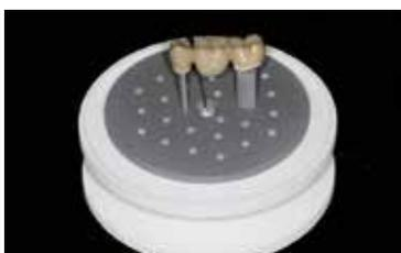
Effettuare la cottura di glassura p.es. nel forno Programat CS4. Posizionare il Crystallization Tray direttamente sul piano di sinterizzazione.
