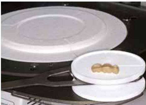
Dopo il processo di sinterizzazione prelevare con la forchetta il piano di sinterizzazione dal forno e lasciare raffreddare sempre i restauri a temperatura ambiente prima di proseguire con la lavorazione.
