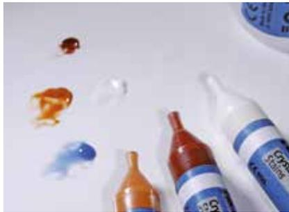
Prelevare IPS e.max CAD Crystall./Shade e Stains dalla siringa e miscelare. Se necessario, diluire con IPS e.max CAD Crystall./Glaze Liquid.
