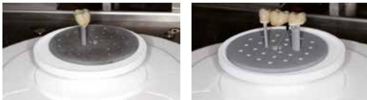
Posizionare il restauro sull'IPS e.max CAD Crystallization Tray ed effettuare la cottura con il programma di cottura indicato. Utilizzando il forno Programat CS4, posizionare sul piano di sinterizzazione.
