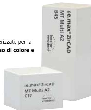
**IPS e.max ZirCAD MT Multi** è composto da due diverse materie prime: da uno 4Y-TZP con una traslucenza media (MT) e da uno 5Y-TZP con una traslucenza elevata (HT). La combinazione di questi due materiali consente di ottenere un'ottimale luminosità nell'area dentinale ed un'elevata traslucenza in area incisale.
