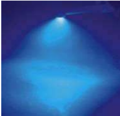
Fig. 19a. Ampia diffusione della luce quando il LED è montato anteriormente.
