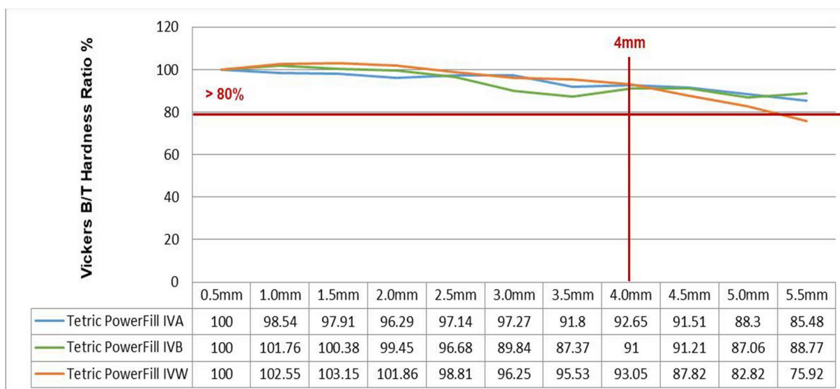
Fig. 42. Rapporti di durezza Vickers lato inferiore/lato superiore a intervalli di 0,5 mm per ciascun colore di Tetric PowerFill.
