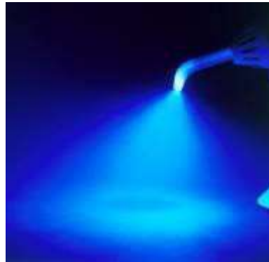
Fig. 19b. Diffusione della luce di un conduttore ottico con conicità molto accentuata ( 13 > 8 mm)
