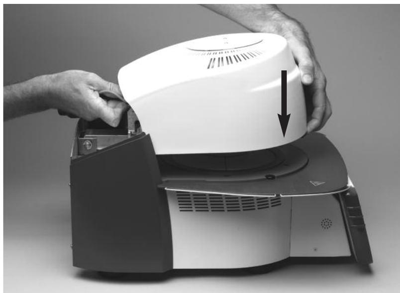
Assicurarsi che la tacca di demarcazione di montaggio della cappa (41) sia allineata con la tacca di demarcazione di montaggio della base del forno (42).
