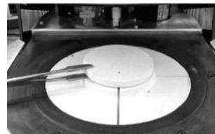
3. Con la pinza afferrare con cautela la parte superiore dell'ATK 2 (Attenzione: pericolo di frattura della ceramica) e inserirlo nell'apposito foro fino ad avvertire uno scatto.
