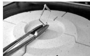
4. Se necessario, con la pinza premere leggermente al centro dello zoccolo di calibratura fino ad avvertire uno scatto, segno che il campione per la calibratura è stato alloggiato correttamente. Prestare attenzione alle tacche di demarcazione.
