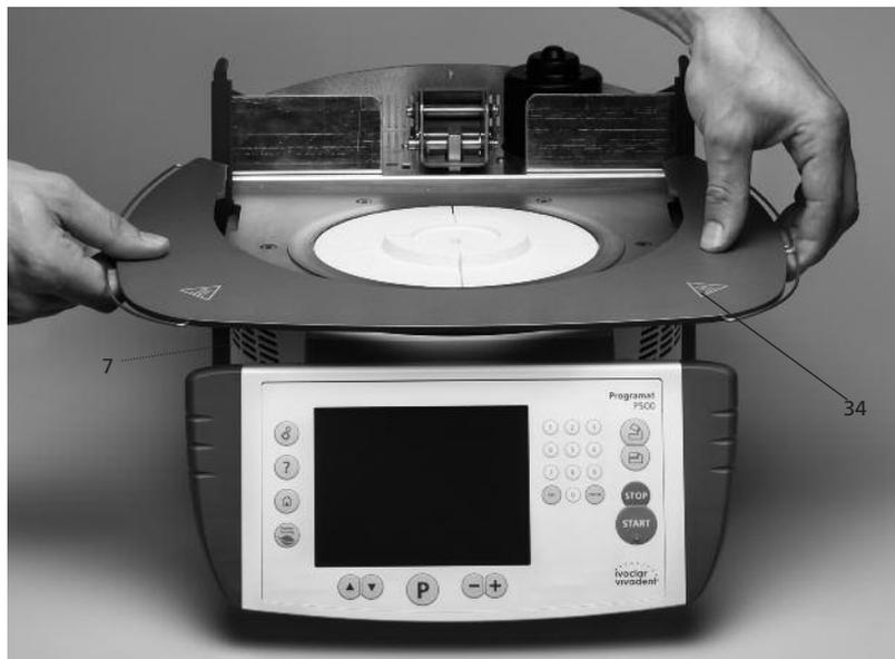
A questo punto fissare la piastra di appoggio (34) con le due viti di fissaggio (35) includendo la superficie in silicone (47).
