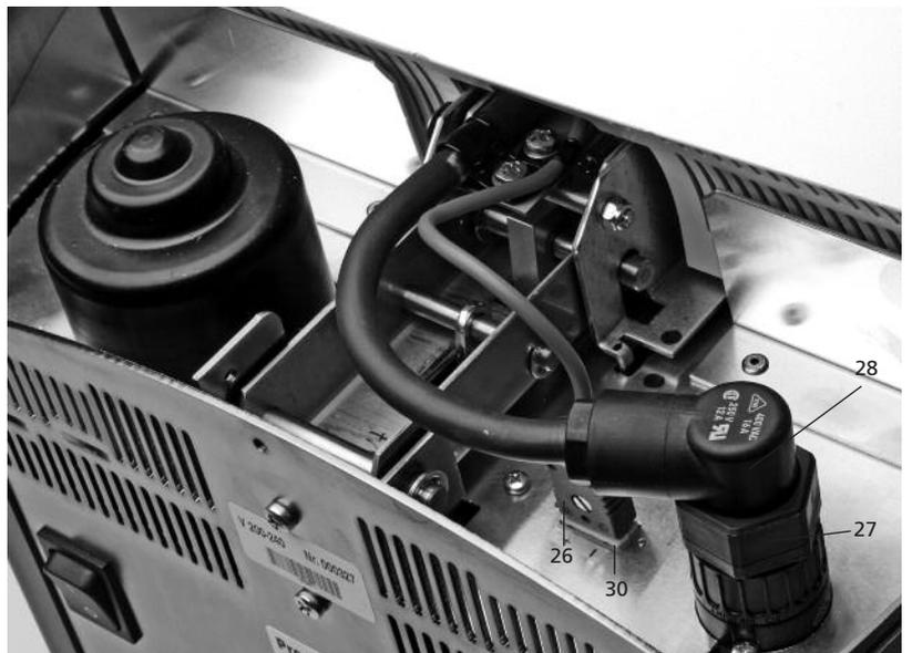
Fissare la spina della resistenza (28) mediante la ghiera a vite (27) che viene girata fin quando la spina della resistenza (28) è ferma.
