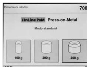
A questo punto, per determinati materiali, è possibile selezionare la dimensione del cilindro (100 g, 200 g, 300 g). Questa selezione è prevista sia per i programmi standard che per quelli IPF (esempio: cilindro 300 g per IPS InLine PoM).
