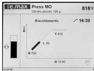
Schermata dello stato operativo durante un programma di pressatura in modalità standard. Non appena il processo di pressatura ha inizio, una freccia aggiuntiva segnala che il pistone di pressatura si sta muovendo verso il basso. A schermo viene visualizzato una volta il tempo totale del ciclo di pressatura e, nella unità di misura selezionata, il percorso che il pistone di pressatura ha già compiuto dall'inizio del processo di pressatura.
