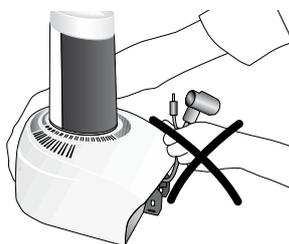
Non sorreggere la cappa mediante i cavi. Cavi e connessioni potrebbero danneggiarsi.
