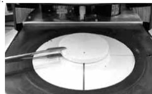
3. Con la pinza afferrare con cautela la parte superiore dell'ATK 2 (Attenzione: pericolo di frattura della ceramica) e inserirlo nell'apposito foro fino ad avvertire uno scatto.
