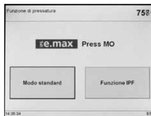
Determinati materiali possono essere pressati, oltre che con i noti programmi di pressatura standard Ivoclar Vivadent, anche utilizzando la nuova modalità IPF (Funzione pressatura Intelligente) (cfr. Capitolo 6.3.3). Per i materiali che possono essere pressati anche con la funzione IPF verrà visualizzata la corrispondente schermata di selezione.
