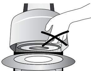
La cappa del forno è dotata di azionamento elettrico e deve essere comandata tramite l'apposito tasto di apertura e chiusura. Non aprire mai la cappa manualmente per non danneggiarne il meccanismo.
