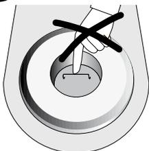
Non toccare il termoelemento e il tubo di quarzo della camera di cottura. Evitare qualsiasi contatto delle parti con la pelle (contaminazione da grasso) per non usurare più rapidamente le componenti.
