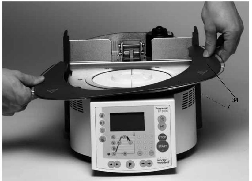
A questo punto fissare la piastra di appoggio (34) con le due viti di fissaggio (35) includendo la superficie in silicone (47).
