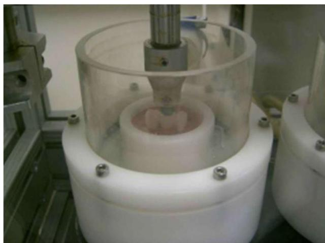
Fig. 9: Simulatore di masticazione Willytec
