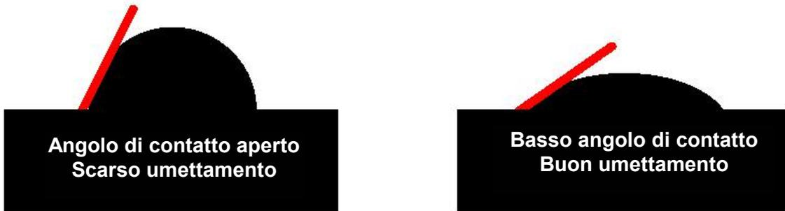
Il metodo tradizionale di misurazione dell'angolo di contatto prevede l'utilizzo di materiale d'impronta polimerizzato. Una goccia d'acqua è posta su un campione di materiale d'impronta polimerizzato e si misura il suo angolo di contatto. L'angolo di contatto è indice della bagnabilità del materiale d'impronta con acqua. Tuttavia non è un reale indicatore della sua capacità d'umettamento dell'ambiente orale umido e dei tessuti molli.
