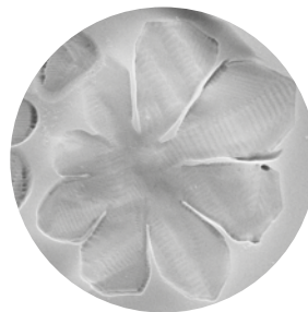
Leucite cristallina Espansione controllata e resistenza (ingrandimento x8.200)
