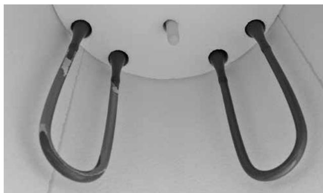
Sul termoelemento sinistro lo strato di protezione si è in gran parte staccato. Il termoelemento destro è in buono stato, stabile, con uno strato di ossido protettivo intatto. La cottura di pulizia deve essere ripetuta finché la superficie è nuovamente libera da impurità ed ha un aspetto vetroso.
