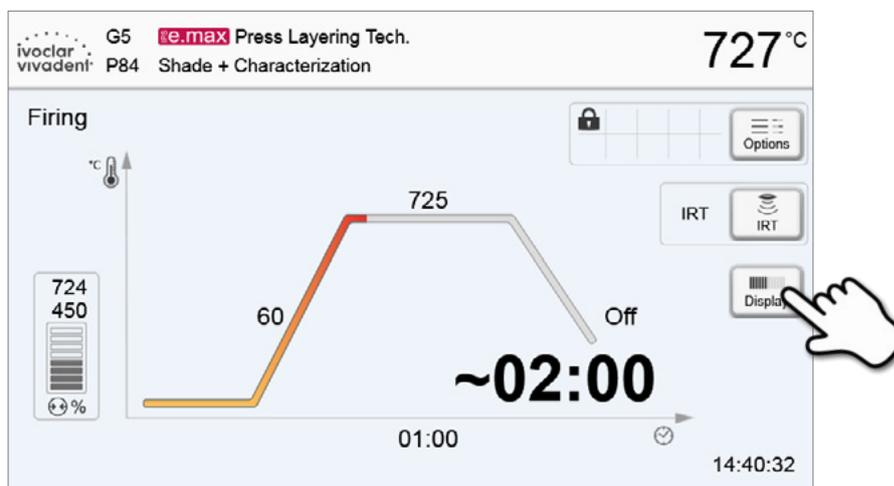
Premendo il tasto **[Display]** dalla curva di cottura, si passa alla visualizzazione del tempo rimanente. La visualizzazione del tempo rimanente informa l'utente anche a grande distanza in merito al tempo necessario al termine del processo, raffigurato a caratteri ben leggibili al centro del display.
