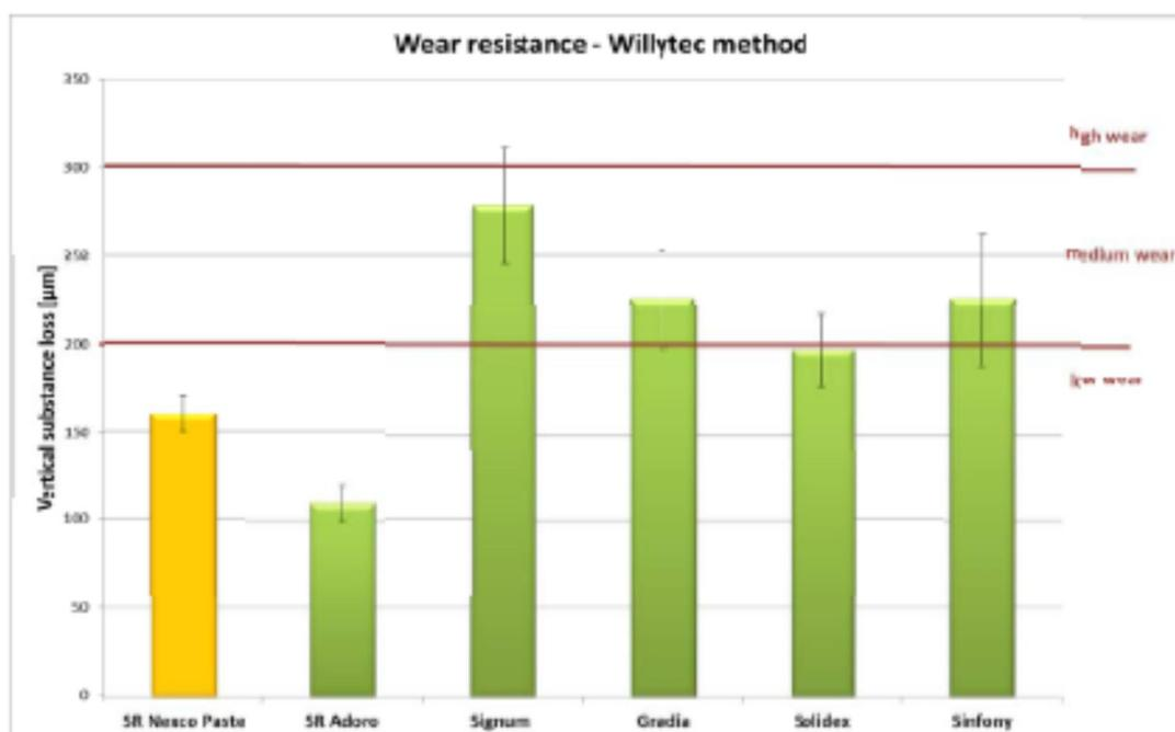
Fig. 17 comparazione della resistenza all'usura di diversi compositi da laboratorio. R&S Ivoclar Vivadent, Schaan, aprile 2011.
