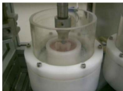
Fig. 16 simulatore di masticazione Willytec
