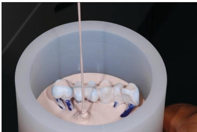
*L'imperniatura viene eseguita sulla base della muffola IPS e.max sempre in direzione del flusso e nel punto di massimo spessore.*
