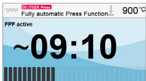
Al termine del programma, la cappa del forno si apre automaticamente. Sul pannello dei risultati, vengono visualizzati il tempo ed il tragitto di pressatura.
