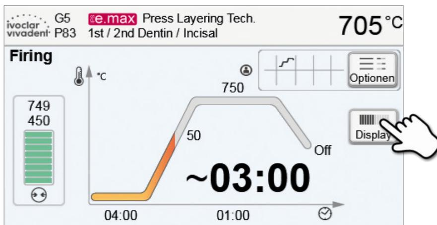
Premendo il tasto **[Display]** dalla curva di cottura, si passa alla visualizzazione del tempo rimanente. La visualizzazione del tempo rimanente informa l'utente anche a grande distanza in merito al tempo necessario al termine del processo, raffigurato a caratteri ben leggibili al centro de display.
