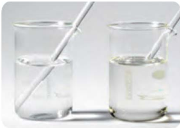
Fig. 5: : Immagine dell'indice di rifrazione, con barre di vetro immerse in acqua (sinistra) e in una miscela monomerica con indice di rifrazione specifico (destra)
