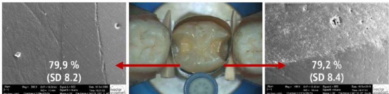
Fig. 28a-c: Analisi marginale di Tetric EvoCeram (SEM, sinistra) e Tetric EvoCeram Bulk Fill (SEM, destra)
