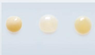
Situazione iniziale: Tetric EvoFlow (sinistra), SDR Flow\* (centro) e Palfique Estelite LV\* (destra) sono stati applicati su barre di vetro posizionate verticalmente.
