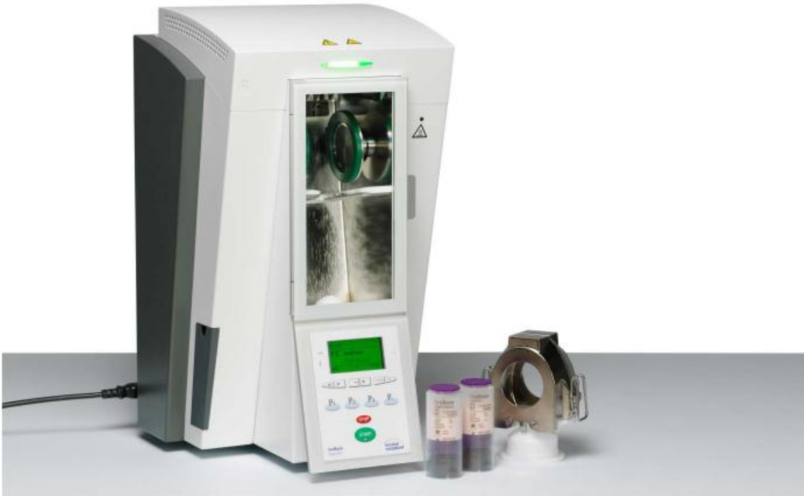
Fig. 1: Il sistema IvoBase è composto dall'apparecchio IvoBase Injector (sinistra) e dalle capsule preosate del materiale IvoBase Hybrid e del materiale ad elevata resistenza all'urto IvoBase High Impact (al centro). A destra, la muffola dove avviene la messa in rivestimento del modello per la polimerizzazione.
