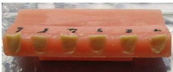
Fig. 8a: Legame di denti SR Vivodent DCL con IvoBase Hybrid. Test conforme alla norma EN ISO 22112. Misurazioni interne, Ivoclar Vivadent
