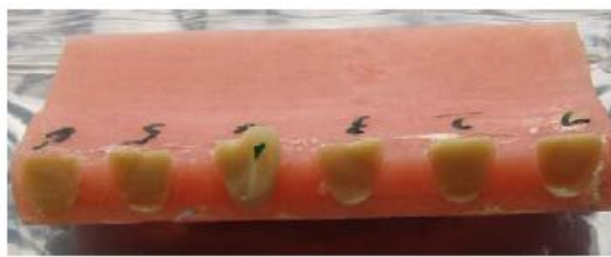
Fig. 8b: Legame di denti SR Vivdent DCL con IvoBase High Impact. Test conforme alla norma EN ISO 22112. Misurazioni interne, Ivoclar Vivadent.
