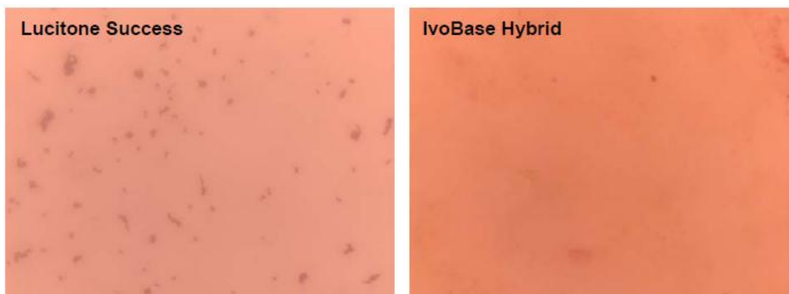
Fig. 14: Colonizzazione C. albicans su Lucitone Success e IvoBase Hybrid dopo 30 minuti di incubazione con preventiva immersione dei campioni in saliva. Un numero visibilmente maggiore di cellule si è adeso a Lucitone Success rispetto a IvoBase Hybrid.
