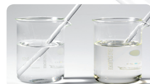
A destra, l'indice di rifrazione alla luce del monomero corrisponde a quello del filler, mentre quello riportato sulla sinistra non corrisponde.
